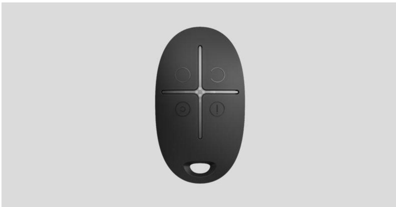
**SpaceControl** es un mando en miniatura con protección contra clics accidentales. Permite poner el sistema de seguridad Ajax en modo armado, noche o desarmado, así como activar la alarma.
