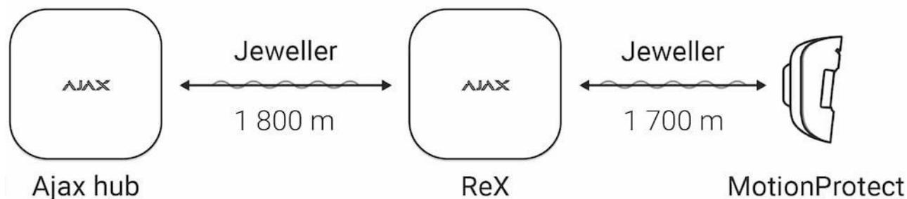
El rango de comunicación entre ReX y el dispositivo está limitado por el rango de la señal de radio del dispositivo (indicado en las especificaciones del dispositivo en la web y en el Manual de usuario).
