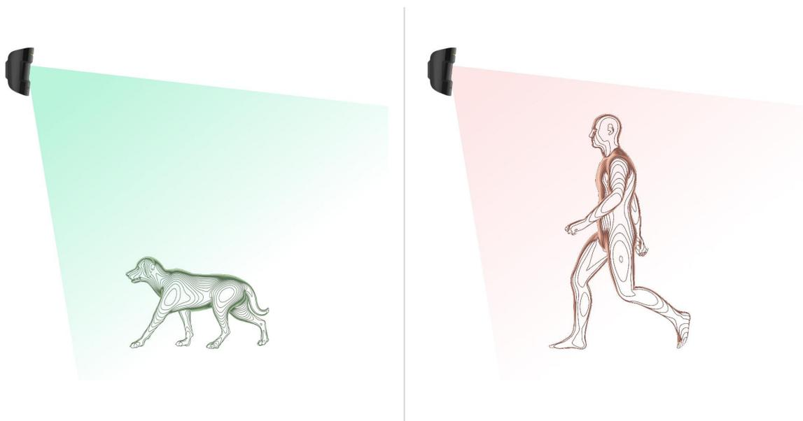
El detector se debe instalar a 2,4 metros sin obstruir su visión. Por ejemplo, en una esquina donde no se bloquee su visión con un armario u otros muebles a los que una mascota puede subir.
