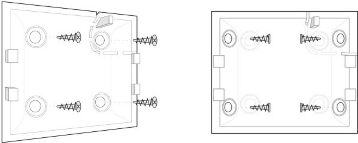
**8.** Fije el detector en el panel de montaje SmartBracket.
