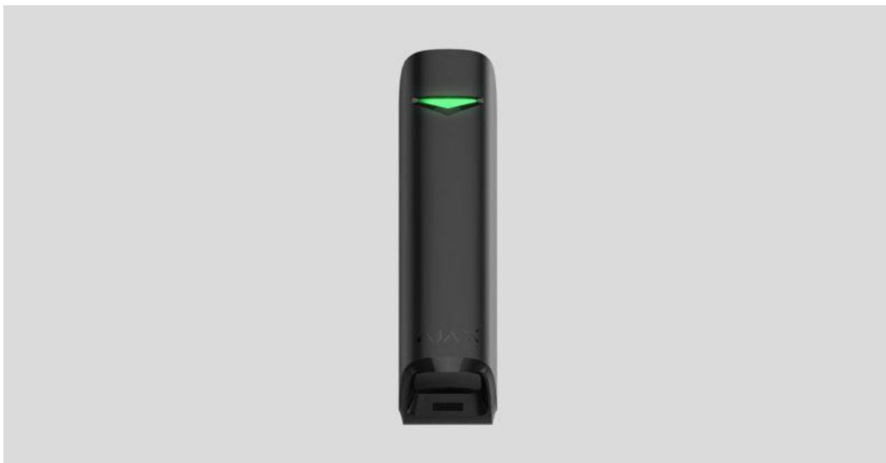
El **MotionProtect Curtain** es un detector inalámbrico de movimiento tipo cortina. El detector tiene un ángulo de detección horizontal estrecho y está diseñado para controlar el perímetro interior: proteger ventanas, puertas y otras entradas y salidas de la instalación protegida. El MotionProtect Curtain reconoce el movimiento a una distancia de hasta 15 metros.
