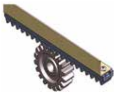
SOBRA NO ENGRENAMENTO, O CONJUNTO ESTÁ CORRENDO
