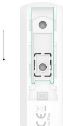
2. Si está utilizando un imán grande, quite el panel de montaje SmartBracket de él, presionándolo suavemente y tirándolo hacia abajo como se muestra en el paso anterior. Si está utilizando un imán pequeño, desmantele su carcasa levantando la parte trasera con un objeto plano. Utilice un destornillador plano para esto.
